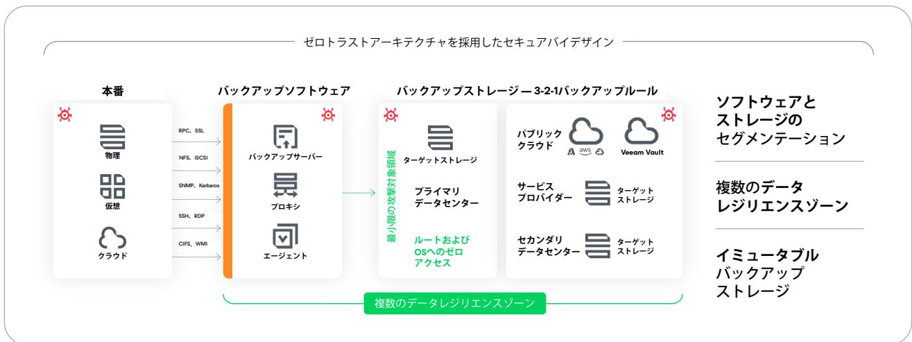
図2：ゼロトラストのデータレジリエンス：リファレンスアーキテクチャ
